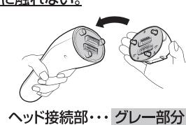
※ガラス管が破損した場合は、破片が散らばらないように必ず新聞紙などの紙の上でフラッシュヘッドを外してください。
